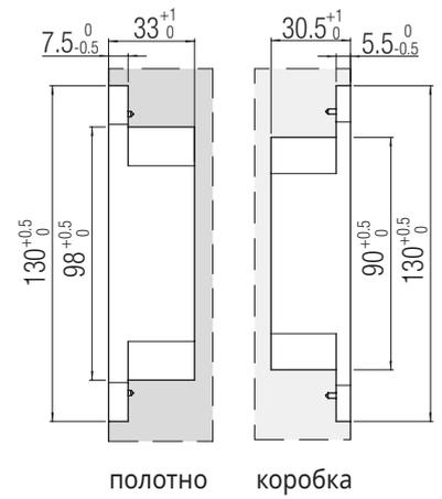
Установка петли по центру дверного полотна
