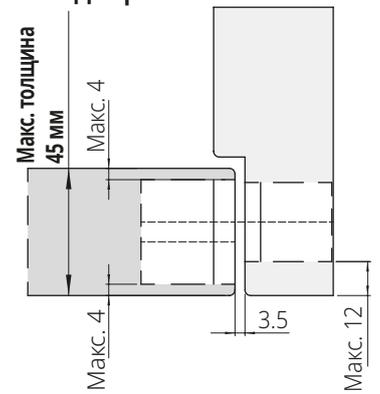
Установка петли НЕ по центру дверного полотна
