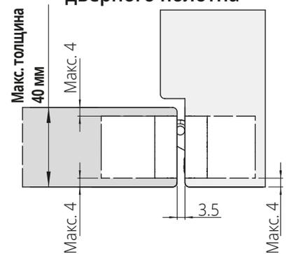
Установка петли НЕ по центру дверного полотна
