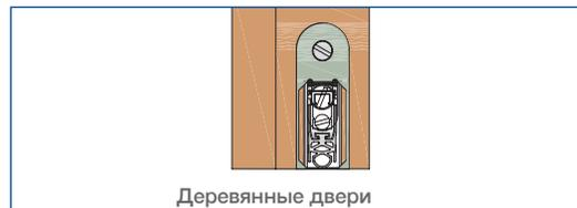
• **ХАРАКТЕРИСТИКИ** Механизм (ПАТЕНТ) параллельного опускания подвижного профиля с прокладкой, который имеет ДВОЙНУЮ РЕГУЛИРОВКУ (винт E: опускание – винт R: наклон) для сильного и равномерного прижима по всей длине.
