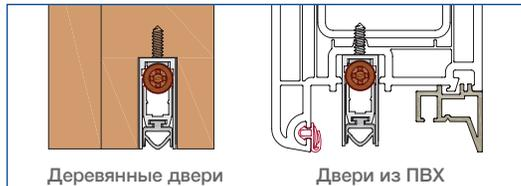
• **ХАРАКТЕРИСТИКИ** Механизм с одним видом регулировки (винт F: опускание), который характеризуется управляемым движением подвижного профиля с прокладкой (немедленное опускание со стороны петель и последующее постепенное опускание по всей длине) для правильного прижима к полу.
