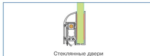
• **ХАРАКТЕРИСТИКИ** Механизм с одним видом регулировки (винт F: опускание), который характеризуется управляемым движением подвижного профиля с прокладкой (немедленное опускание со стороны петель и последующее постепенное опускание по всей длине) для правильного прижима к полу.
