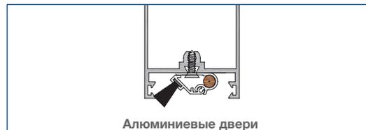
• **ХАРАКТЕРИСТИКИ** Механизм с одним видом регулировки (винт G: опускание), который характеризуется постоянным опусканием подвижного профиля с прокладкой к полу.
