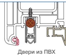
• **ХАРАКТЕРИСТИКИ** Механизм с одним видом регулировки (винт F: опускание), который характеризуется управляемым движением подвижного профиля с прокладкой (немедленное опускание со стороны петель и последующее постепенное опускание по всей длине) для правильного прижима к полу.
