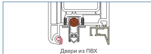
• **ХАРАКТЕРИСТИКИ** Механизм с одним видом регулировки (винт F: опускание), который характеризуется управляемым движением подвижного профиля с прокладкой (немедленное опускание со стороны петель и последующее постепенное опускание по всей длине) для правильного прижима к полу.
